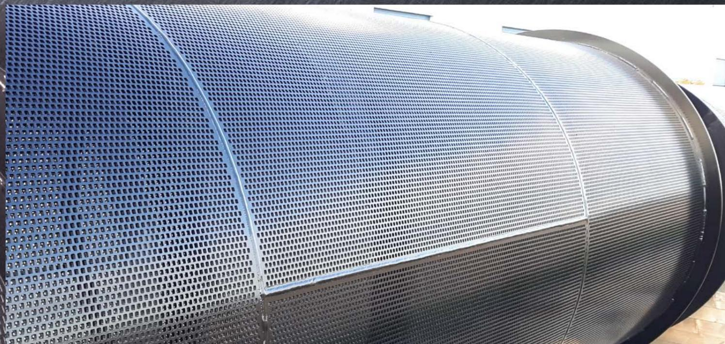
Tous nos tambours sont fabriqués en acier S355. L'épaisseur de la tôle qui peut être de 6,8 ou 10 mm. La taille et la forme des perforations est également en fonction des besoins du client - nous pouvons fabriquer des tambours à perforation carrée ou circulaire ayant un diamètre de 8 à 100 mm. Les ponts entre la perforation et l'épaisseur de paroi de la spirale peuvent être adaptés aux besoins individuels des clients. Nous vendons des tambours pour les machines suivantes:
